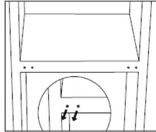
11. Stellen Sie das Gerät auf und platzieren Sie die Tür am unteren Scharnier. Stellen Sie sicher, dass der Kern des unteren Scharniers in das Türloch eingesetzt ist. Dann mehr die Scharnierlochabdeckung der unteren Tür von links nach rechts.
