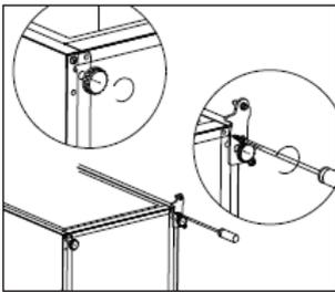
8. Skruva loss och ta bort den nedre gångjärnsbulten, vänd på fästet och
