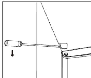
4. Flyt kernedækslet fra venstre side til højre side. Og løft derefter den øverste dør og placer den på en polstret overflade for at forhindre, at den ridser.
