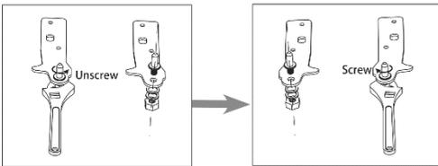
9. Installieren Sie das Scharnier und die Fußbasis auf der rechten Seite. Befestigen Sie dann die beiden Nivellierfüße wieder.
