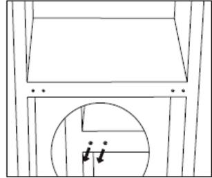
11. Rejs enheden og placer lågen på det nederste hængsel. Sørg for, at hullet på det nederste hængsel er indsat i dørhullet. Flyt derefter hængsel-dækslet på den nederste dør fra venstre mod højre side.
