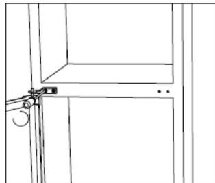
13. Monter den øverste dør med det øverste hængsel.
