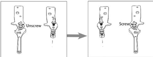
9. Installer hængslet og fodbunden på højre side. Fastgør derefter de to nivelleringsfødder igen.
