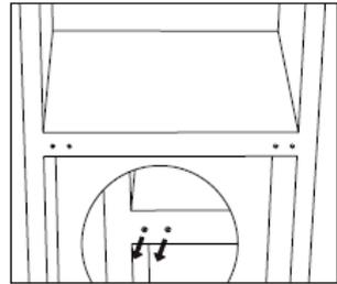
11. Ställ upp enheten och placera dörren på det nedre gångjärnet. Se till att den nedre gångjärnskärnan är införd i dörrhålet. Sedan mer gångjärnshålet på den nedre luckan från vänster till höger sida.
