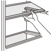
Die Wände des Kühlschranks sind mit einer Reihe von Führungsschienen ausgestattet, so dass die Regale nach Belieben positioniert werden können.
