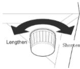
Om enheten inte är plant kommer dörrarna och den magnetiska tätningen inte att täckas på rätt sätt.
