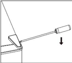
2. Skruva loss det övre gångjärnet med en stjärnskruvmejsel.
