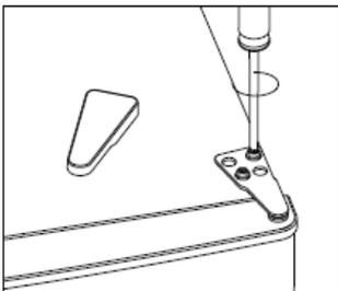
3. Ta bort hålkåpan med en platt skruvmejsel.
