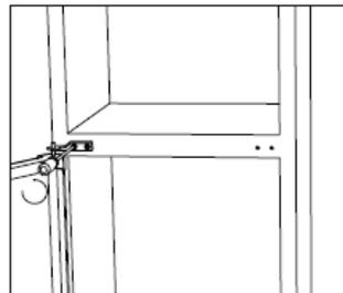
13. Montieren Sie die obere Tür mit dem oberen Scharnier.
