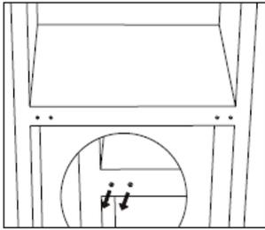
7. Läg dig på baksidan av skåpet på en mjuk dyna. Och skruva loss det nedre gångjärnet och utjämningsfoten.
