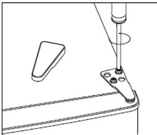
3. Entfernen Sie die Lochabdeckung mit einem flachen Schraubendreher.
