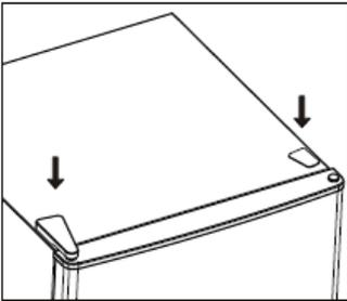
15. Kontrollera om dörrpackningen är deformerad. om ja, ta loss kylan och frys-dörrens packningar och fäst dem sedan efter att de har roterats.
