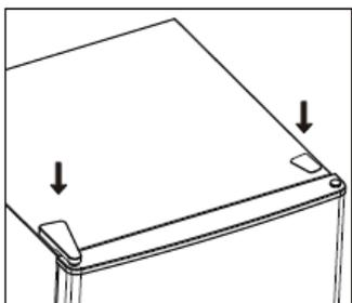
15. Tjek om dørpakningen er deform. Hvis ja, afmonter køleskabet og fryserdørens pakninger og sæt dem derefter på efter rotation.
