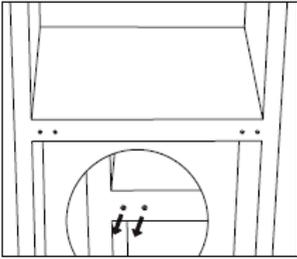
7. Legen Sie die Rückseite des Gehäuses auf eine weiche Unterlage. Und schrauben Sie das untere Scharnier und den Nivellierfuß ab.
