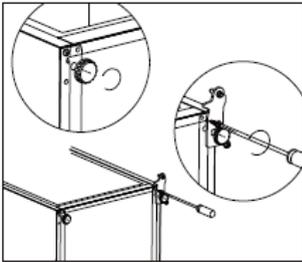
8. Lösen und entfernen Sie den unteren Scharnierstift, drehen Sie die Halterung um und ersetzen Sie sie.
