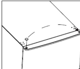
5. Schrauben Sie das mittlere Scharnier ab und heben Sie dann die untere Tür an und legen Sie sie auf eine weiche Unterlage, um Kratzer zu vermeiden.
