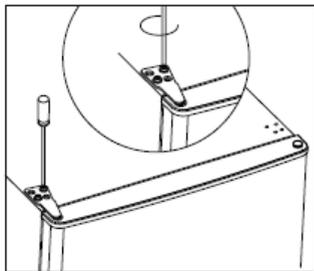
14. Klicken Sie auf die Scharnierabdeckung und die Lochabdeckung auf der Oberseite des Geräts.
