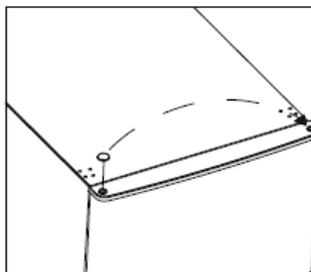
5. Skru det midterste hængsel af og løft derefter den nederste dør og læg den på en blød pude for at undgå ridser.
