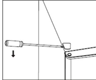
4. Bewegen Sie die Kernabdeckung von der linken Seite zur rechten Seite. Heben Sie dann die obere Tür an und legen Sie sie auf eine gepolsterte Oberfläche, damit sie nicht zerkratzt.
