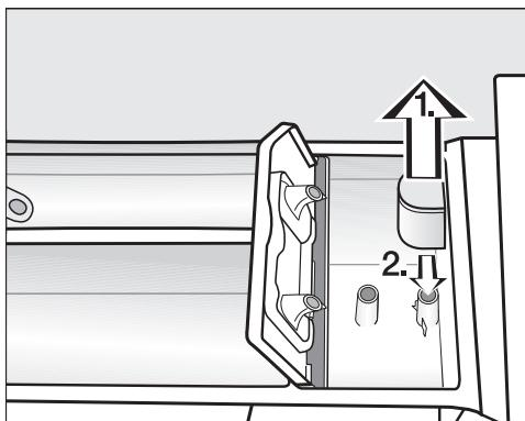
1. Trekk ut sugeheverten fra kammer
