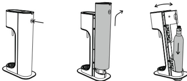
Käännä hiiilihapotuslaitetta eteenpäin ja työnnä hiiilihioksipullo laitteen pohjassa olevaan aukkoon siten, että hiiilihioksipullon jää seisomaan alustalle. Käännä sitten hiiilihapotuslaitetta takaisin taaksepäin siten, että laite nojaa hiiilihioksipullon kiertesiin.
