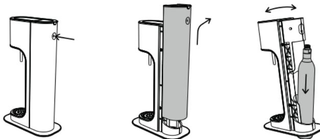
Hold danskvandsmaskinen i en vinkel fremover og før kulsyrepatoronen ned gennem åbningen i bunden af maskinen, så kulsyrepatoronen står på underlaget. Vip derefter danskvandsmaskinen tilbage, så overdelen af maskinen læner ind mod kulsyrepatoronens gevind.
