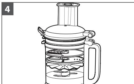
Atunci când nu folosiți robotul de bucătărie, puteți depozita până la două lame și trei discuri, precum și adaptorul pentru ax în interiorul vasului de lucru. În plus, capacul pentru utilizare în frigider poate fi păstrat pe vasul de lucru cu capacul vasului de lucru așezat deasupra. Înfășurați cablul de alimentare în jurul locului pentru depozitarea cablului din partea inferioară a bazei, apoi asigurați ștecarul prințându-l de carcasa.
