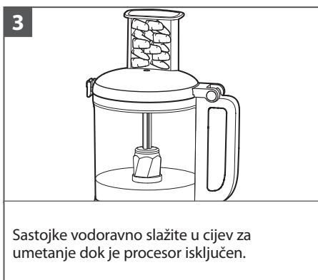
Sastojke vodoravno slažite u cijev za umetanje dok je procesor isključen.
