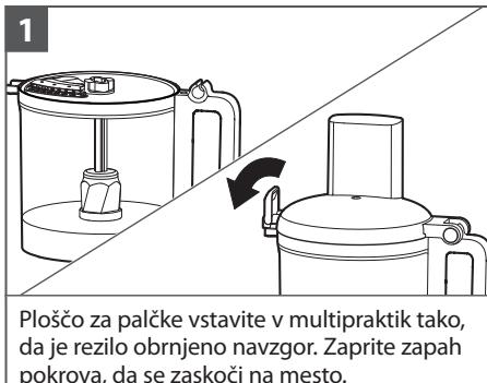
Ploščo za palčke vstavite v multipraktik tako, da je rezilo obrnjeno navzgor. Zaprite zapah pokrova, da se zaskoči na mesto.
