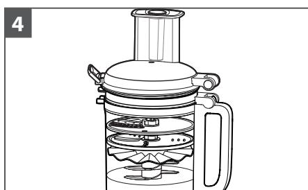
Kada se multipraktik ne upotrebljava, u radnu posudu možete spremiti do dvije oštice i tri diska te pogonski adapter. Osim toga, poklopac za hladnjak može se staviti u radnu posudu, a poklopac radne posude na vrh. Omotajte kabel za napajanje oko spremišta na dnu postolja, zatim pričvrstite utikač za kućište.
