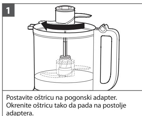
Postavite oštricu na pogonski adapter. Okrenite oštricu tako da pada na postolje adaptora.
