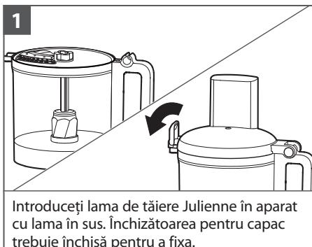
Introduceți lama de tăiere Julienne în aparat cu lama în sus. Închizătoarea pentru capac trebuie închisă pentru a fixa.
