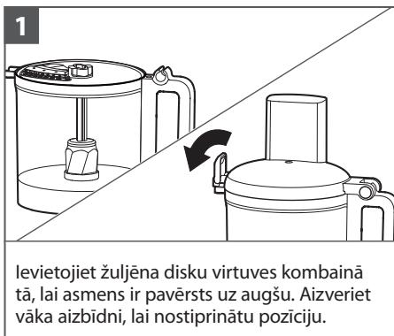
Ievietojiet žuljēna disku virtuves kombainā tā, lai asmens ir pavērts uz augšu. Aizveriet vāka aizbīdni, lai nostiprinātu pozīciju.
